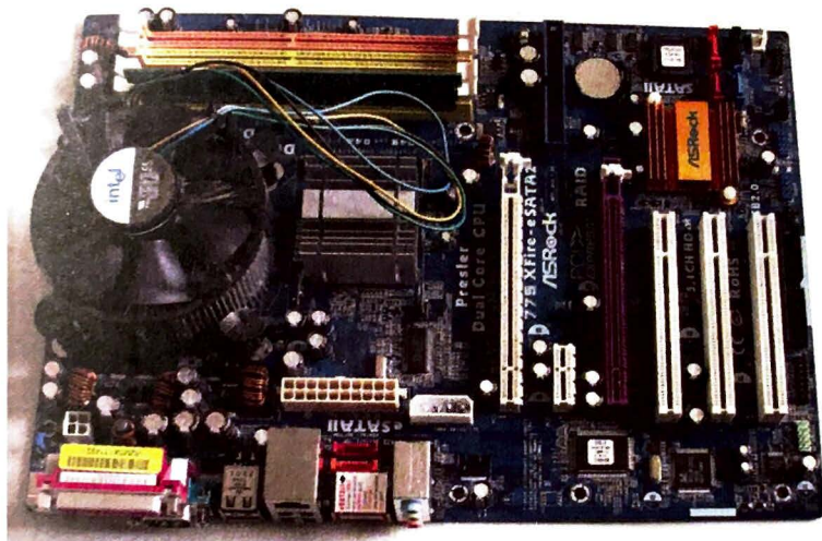
A CPU az alaplapon, egy ventilátor alatt helyezkedik el. Működés közben ugyanis melegszik, ezért hűteni kell.
